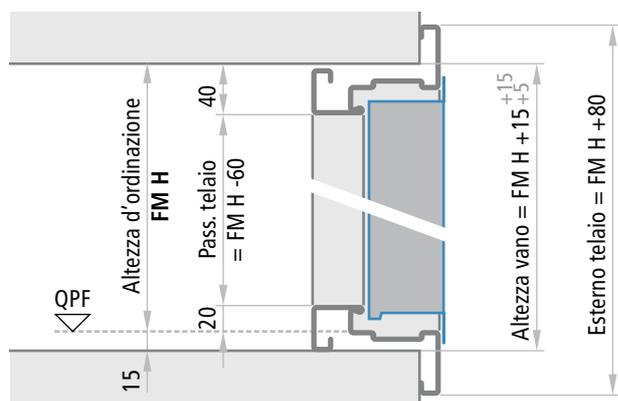
**Porta ad un'anta con telaio a quattro lati e anta senza battuta inferiore**
