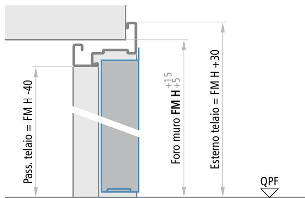
**Porta ad un'anta con telaio a quattro lati e anta con battuta inferiore**
